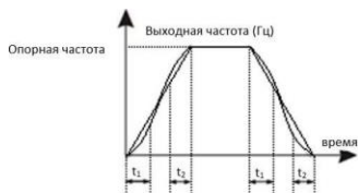
Рис. 6-2 Кривая S разгона/торможения A
