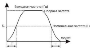
Рис. 6-3 Кривая S разгона/торможения B
