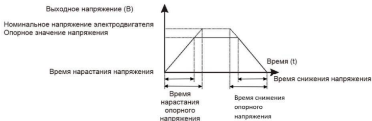
Рис. 6.8 — Время нарастания и снижения напряжения
